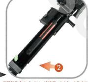
機関部後方のバッテリー接続用コネクターを引き出し専用バッテリーを接続し収納スペースに収納します。
