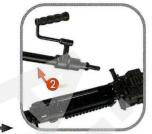
ロックを解除した状態のままバレルユニット を前方斜め上方向へゆっくりと引き抜きます。
