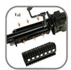
パレル上部のトップカバーを外す際には トップカバー両横の6箇所のネジを取り外し、 ゆっくりとカバーを外してください。
