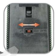
マガジン底部のスイッチを動かし、オートマチック・OFF・音感センサーの3種類のモードが選択できます。
